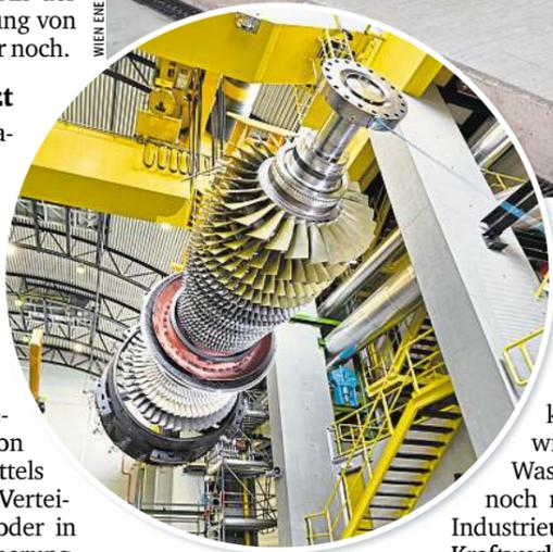
In Wien sollen Brennstoffzellenbusse (o.) auf hügeligen Strecken mit viel Energieverbrauch fahren. Eine Turbine im Kraftwerk Donaustadt (li.) wurde für die Nutzung von Wasserstoff adaptiert
